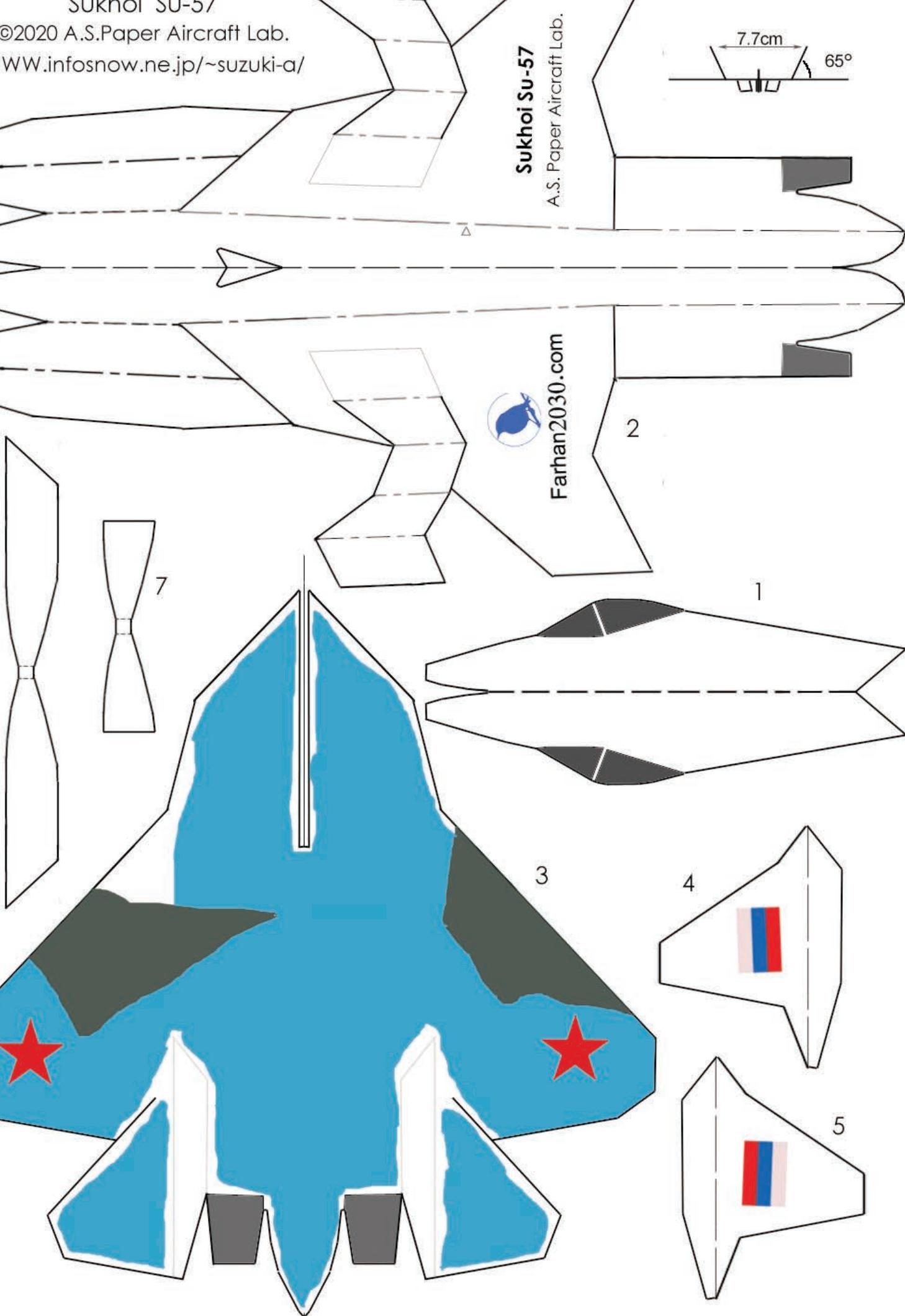
يُرجى اتباع طريقة تجميع الطائرة عبر مدونة فرhan (Farhan2030.com) ومن ثم اتباع ما يلي بالنسبة لهذه الطائرة: ثني الزعانف الخلفية للطائرة إلى الخارج قليلاً (25 درجة لكل منها لخارج مركز الطائرة).
