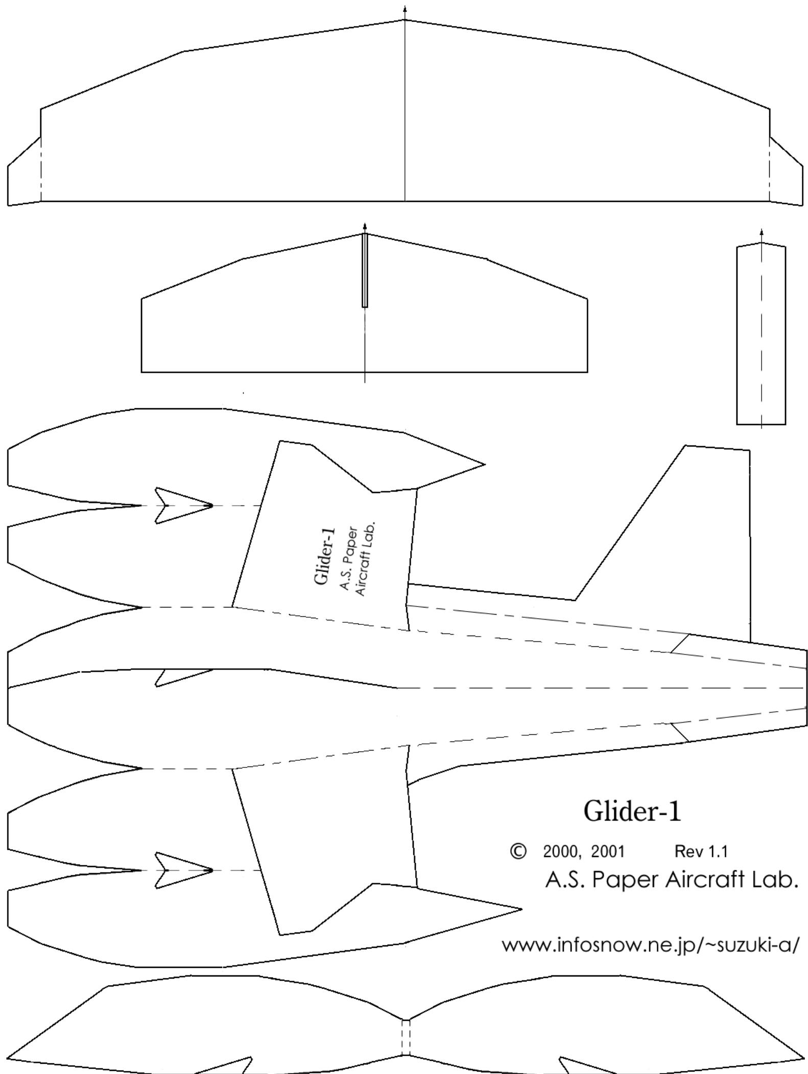
يُرجى اتباع طريقة تجميع الطائرة عبر مدونة فرhan (Farhan2030.com) ومن ثم اتباع ما يلي بالنسبة لهذه الطائرة: قم بثني جناحي الطائرة بالكامل للأعلى قليلاً (5 درجات)، وثني حافتي جناحي الطائرة للأعلى قليلاً (5 درجات).
