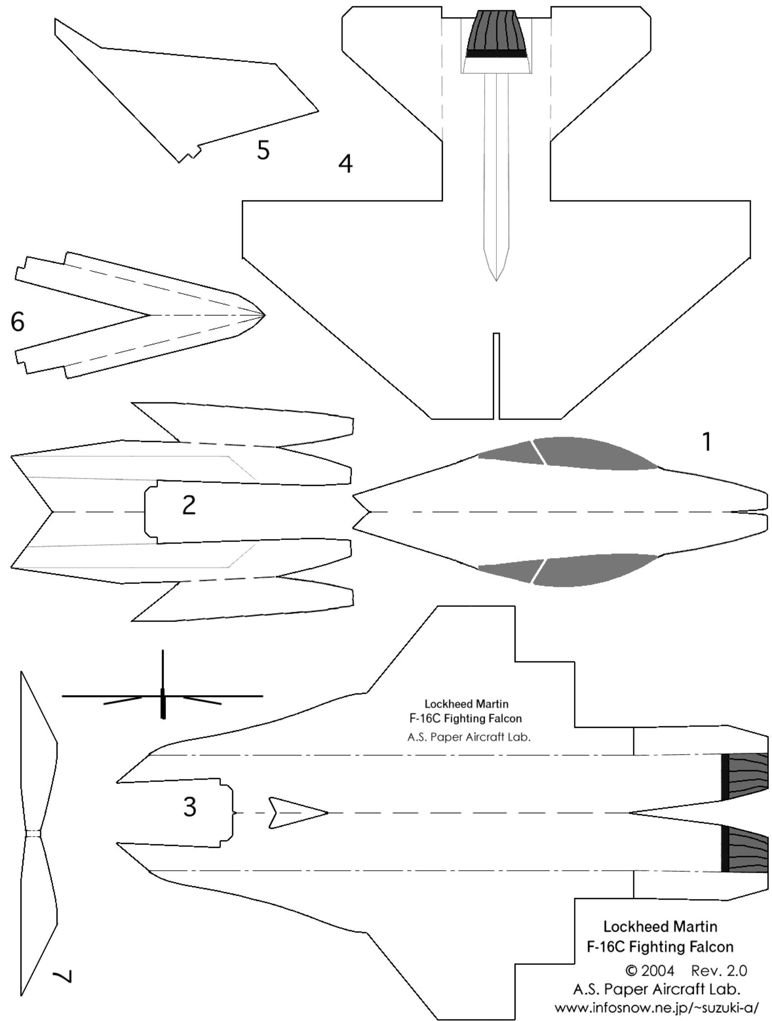
يُرجى اتباع طريقة تجميع الطائرة عبر مدونة فرhan (Farhan2030.com) ومن ثم اتباع ما يلي بالنسبة لهذه الطائرة: قم بثني الروافع عند ذيل الطائرة للأسفل قليلاً (10 درجات) كما هو موضح بالرسم.
