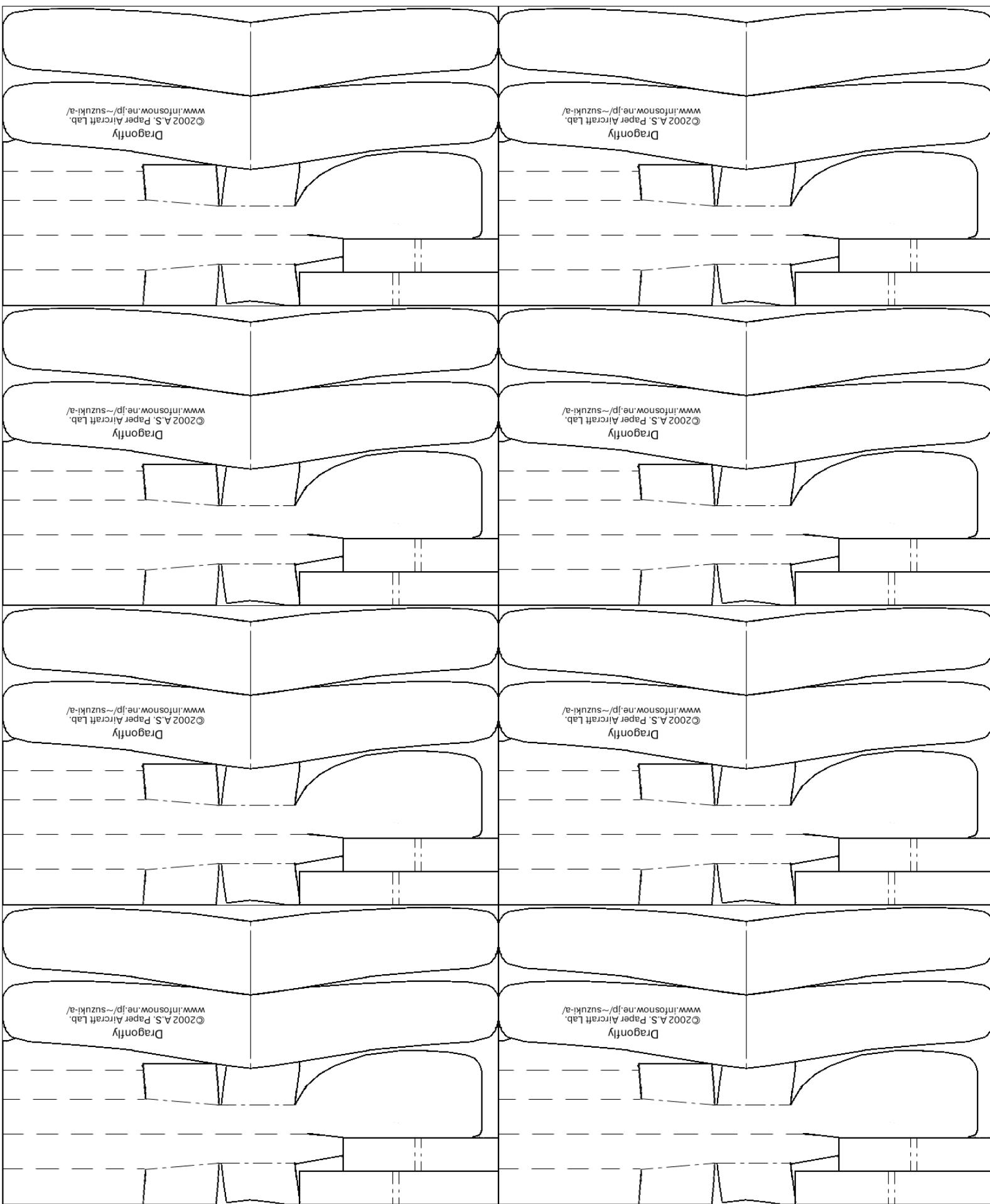
يُرجى اتباع طريقة تجميع الطائرة عبر مدونة فرhan (Farhan2030.com) ومن ثم اتباع ما يلي بالنسبة لهذه الطائرة: قم بثني الأجنحة الأمامية لليعسوب بالكامل للأعلى قليلاً (15 درجات) وإبقاء الأجنحة الخلفية (التي عليها الكتابة) ثابتة أفقياً بدون ثني.
